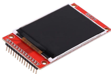
Fig. 3a Front side TFT SPI display
