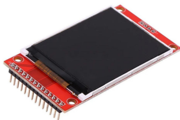
Fig. 3a Front side TFT SPI display
