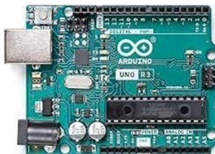
Fig 4: Arduino Uno Board
