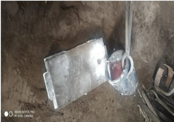
Fig: Pouring the molten metal
