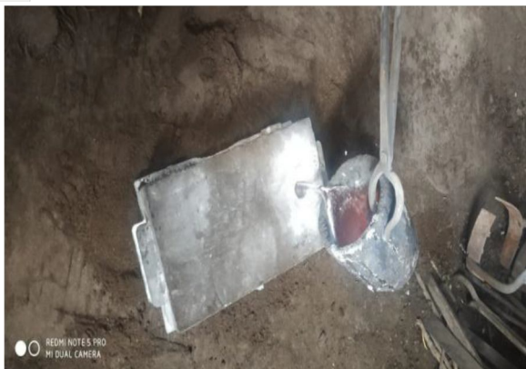
Fig: Pouring the molten metal
