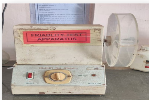
FIG.No. 6: Roche Friability Apparatus
