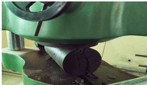
Figure- 2(Split Tensile Test)
