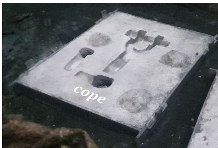
Fig. 11 Actual model of Cope
