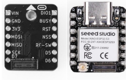
Fig. 2. XIAO ESP32-S3 & Wio-SX1262 module
