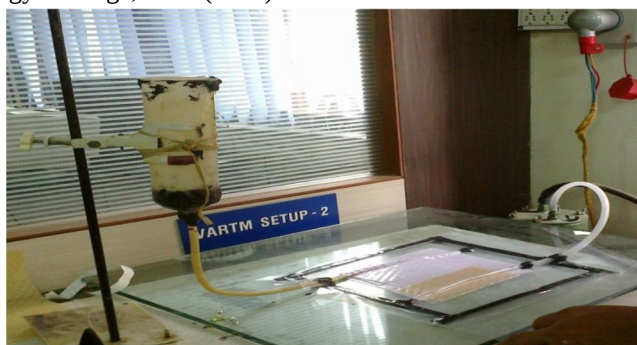
Fig: VARTM setup
