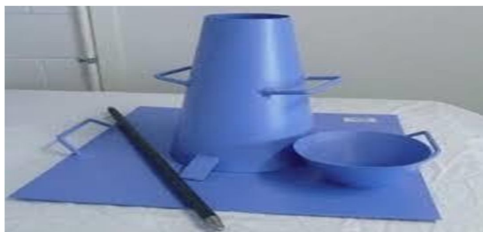
Fig. 5 – Slump cone apparatus
