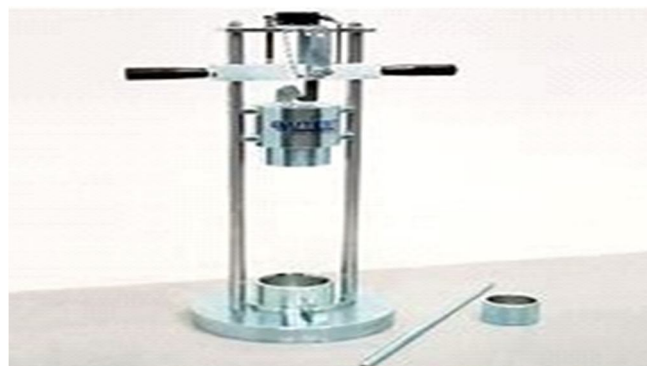
Fig. 13. Crushing Value apparatus
