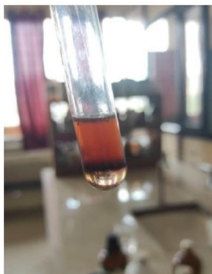
Fig No. 25 Molisch's Test
