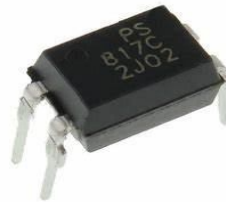
Fig. 3 817C Optocoupler DIP
