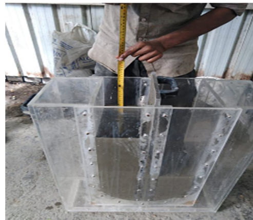
Fig 4. U- Box Test
