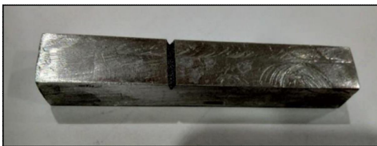
Fig. 4 Aluminium 6061-T6 Izod Test Specimen
