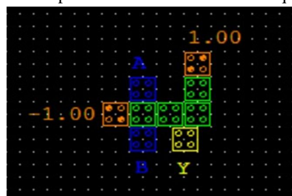
Fig. 2 XOR gate QCA layout
