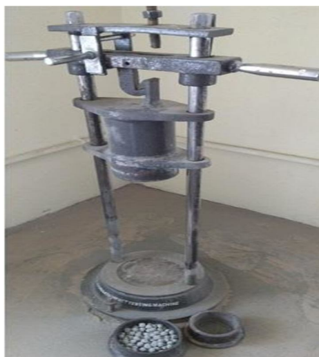
FIG. :-2 Impact Test Appratus
