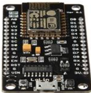
Fig. 3 Node MCU ESP8266 IC
