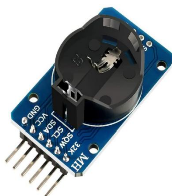
FIG: 4 RTC MODULE
