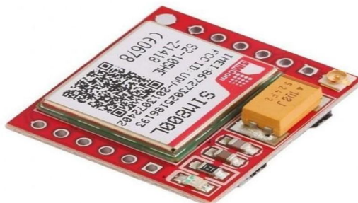
Fig. GSM Module :Sim 800L
