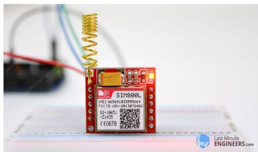
Fig: GSM SIM 800L module
