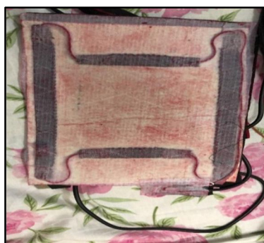
Fig. Heating pad (Nichrome wire)
