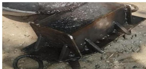
Fig .No. 7.9. Filling Molten Mix In M.S. Mould
