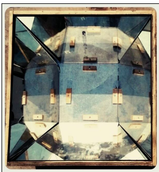
Fig. 3: Trapezium Solar Cooker
