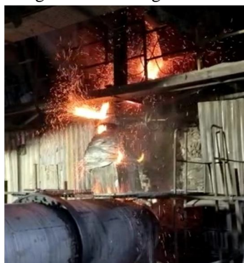
Fig. 4. Slag Leakage in Inlet Pipe
