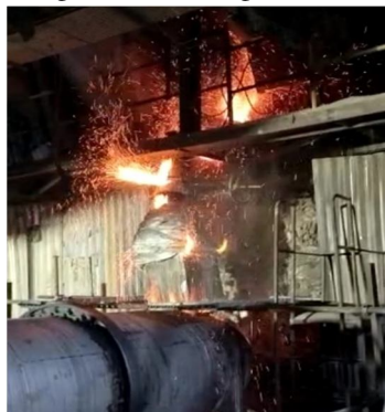
Fig. 4. Slag Leakage in Inlet Pipe
