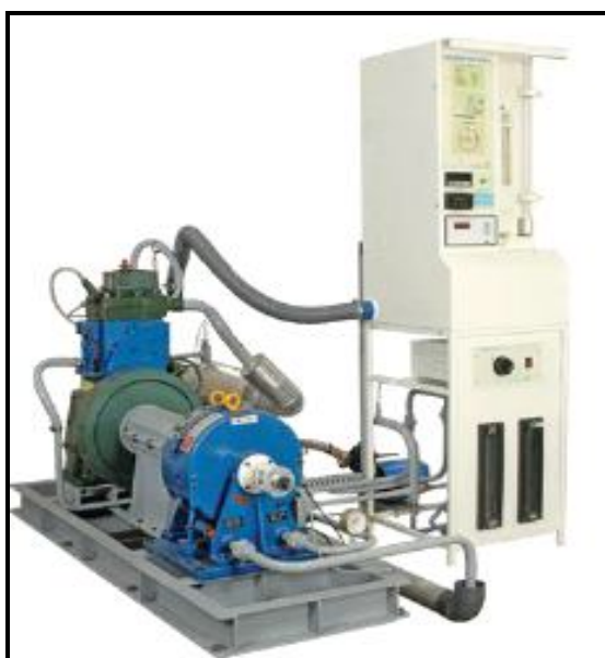
Fig. 2: Actual Setup of Engine Test Rig. [10]
