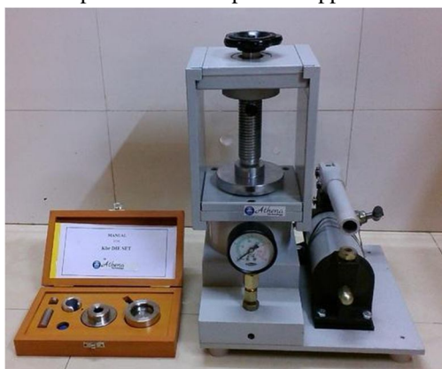
Fig. 5 KBr die set with hydraulic press
