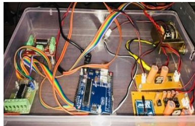
Fig.1 Circuit set up of mini CNC plotter
