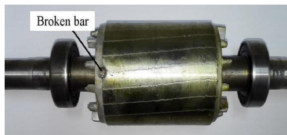
Fig.4 Broken rotor bar
