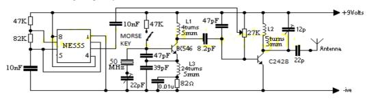
300mW 150MHz Tracking Transmitter
