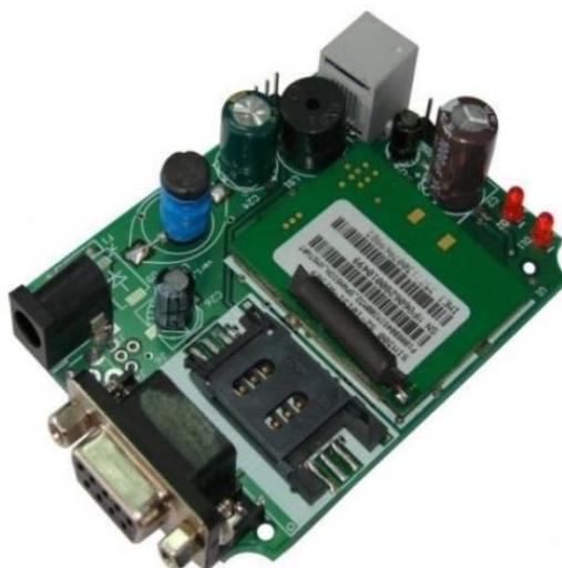
GSM Module SIM 300
