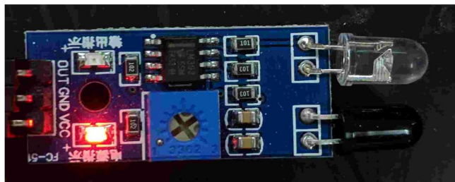
Fig. 6 : IR sensor detecting
