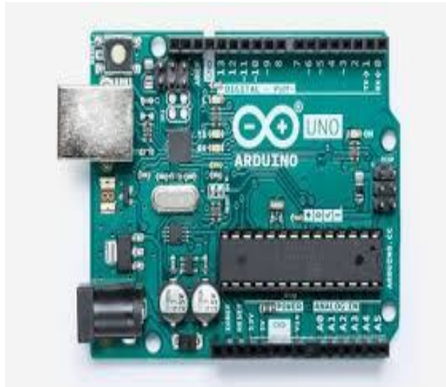
Fig.2.1.2 Arduino Uno R3
