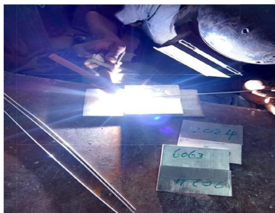
Fig. 3 Tungsten arc welding
