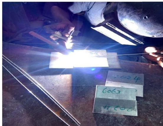
Fig. 3 Tungsten arc welding
