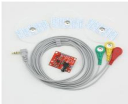
Fig.4: ECG sensor module
