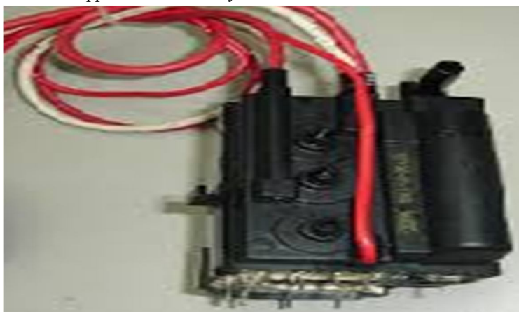
Fig.2 Actual fly back transformer
