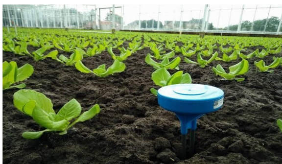
Actual Image of Soil Moisture Sensor.
