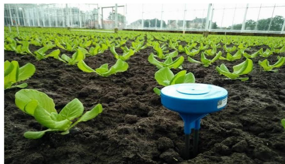
Actual Image of Soil Moisture Sensor.
