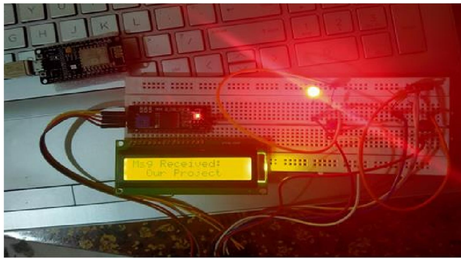
Fig. 10 Message displayed on LCD
