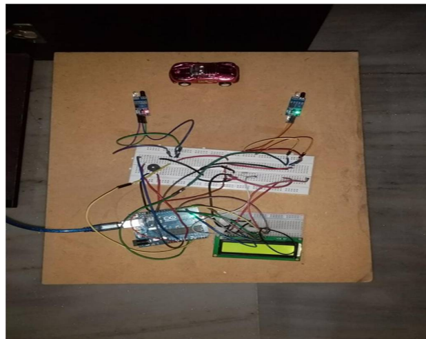
Fig. 10 Speed Sensing Machine Using Arduino Actual Output
