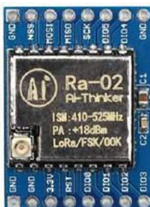
Fig. 7 RA02 LoRa Module
