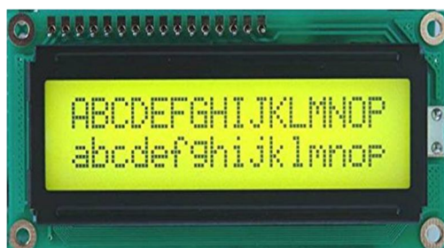
Fig.9 16X2 LCD display
