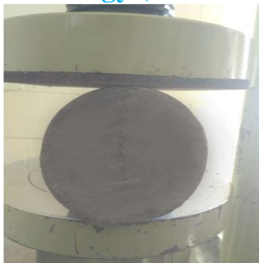
Fig.7 Split Tensile Test
