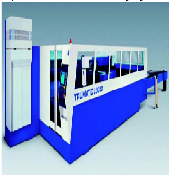
Fig 2: The CO2 laser-machining center (Trumatic L6050)
